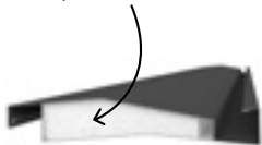
Lamellenaufbau Sandwichbauweise mit Kern aus Peripor.
