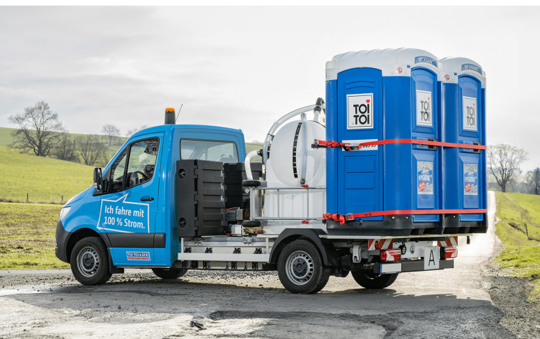
Elektrisch onderhoudsvoertuig voor toiletcabines Krediet: Tobias Kromke, namens TOI TOI & DIXI Fahrzeugtechnik GmbH
