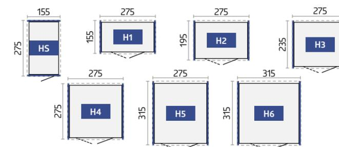
**TIPP:** Sie können das HighLine® ab Gr. H2 ganz nach Ihren Bedürfnissen drehen und die Standardtür kann in jeder Seitenwand eingebaut werden. Ab Gr. H4 ist auch ein seitlicher Einbau der Doppeltür möglich.
