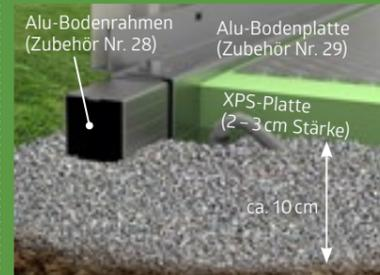
Mit dem **Alu-Bodenrahmen** können Sie das Gerätehaus auch auf einem Splittbett aufstellen und verankern (Bodenanker als Zubehör erhältlich). Die **Alu-Bodenplatte** dient als funktioneller Boden und wird mit XPS-Hartschaumplatten unterfüttert (nicht im Lieferumfang).
